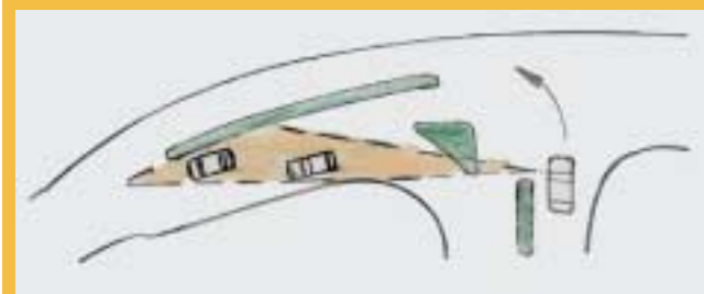
9. ábra: Ívből kikanyarodó járművek beláthatósági problémája
