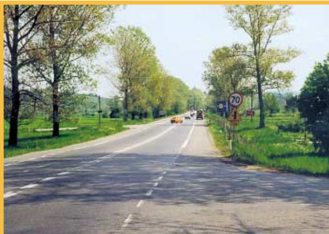
2. ábra: Rosszul látható csomópont kanyarodó sávok nélkül
